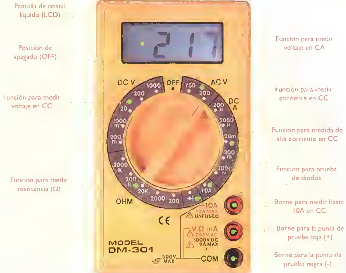
Figura 3.15. Aspecto físico y funciones de un multímetro digital típico
